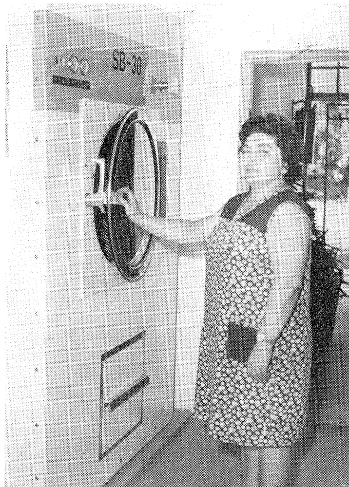
SOUSTRUŽKA BLANKA KVAČKOVÁ OBSLUHUJE BENZINOVÝ ČISTÍCÍ STROJ SB - 30.
